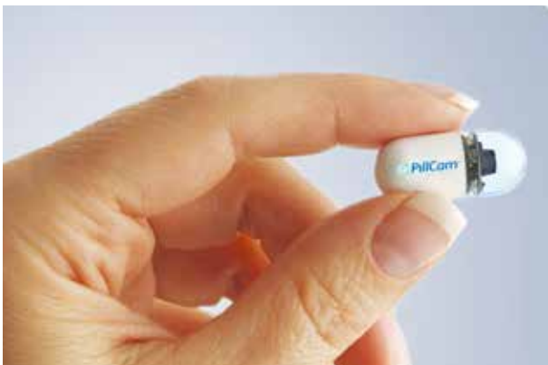
Die Kapsel, die Kamera, Sender und Blitz enthält, lässt sich in der Regel problemlos schlucken.
